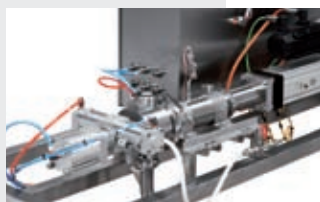
Насос Dosys с приводом Electro-Thrust Cylinder
