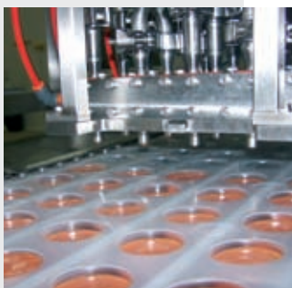
Точность дозирования систем РСМ составляет +/- 0,5%
